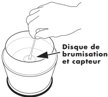
Avec de l'eau tiède ou de l'alcool à friction, nettoyer délicatement le disque de brumisation et le capteur situés à l'intérieur de la base.
